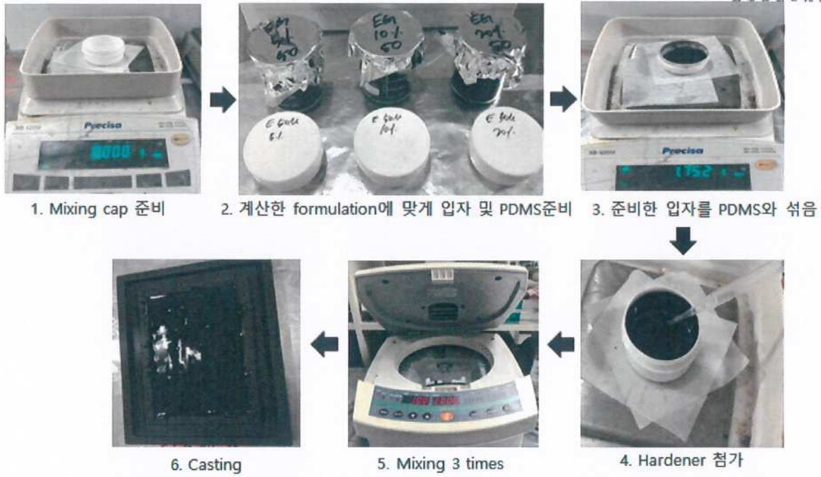
Fig. 2 용매를 사용하지 않은 bulk 중합과정
