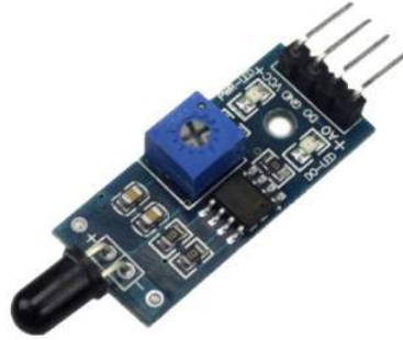
그림 1. NS FDSM 불꽃감지센서
